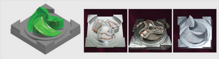
DMT Hybrid-gefertigte Hexaeder Struktur (Material: SUS 420J2)
